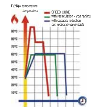
COMPARISON OF CURING SYSTEMS COMPARACIÓN DE SISTEMAS DE SECADO
